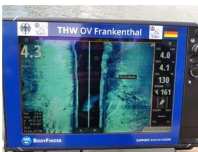
Zusammen mit dem integrierten GPS erleichtert dies zudem die Navigation insbesondere in unbekanntem Flachgewässern und bei schlechten Sichtbedingungen. Im Sommer 2020 konnte das Sonar mit einer Seekarteergänzt werden, was die Navigation auf deutschen Gewässern zusätzlich unterstützt.
