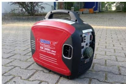
direkt von den an der Einsatzstelle befindlichen Aggregaten bezogen werden. Um unabhängiger agieren zu können, wurde ein kleiner, leiser Stromerzeuger mit einer Leistung von 1,6 kVA beschafft. Dieser befindet sich jetzt auf dem Mannschaftstransportwagen des Zugtrupps und ist somit stets griffbereit.
